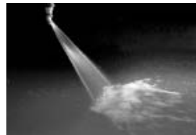
FP serie: Een vlakke straal met hoge slagkracht.
